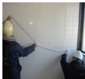
シール等でクラック位置をマーキングしクラック長さを測定
