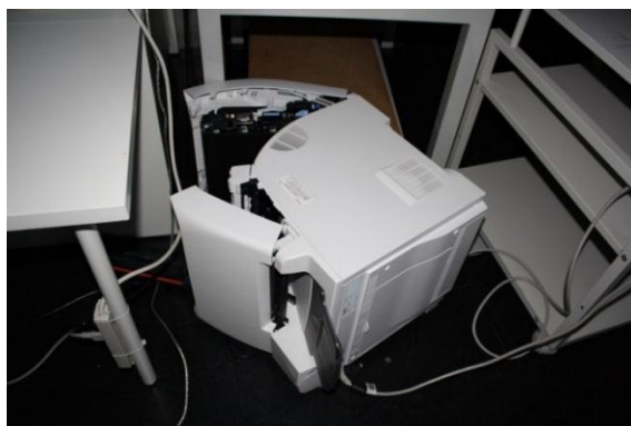
写真5 パソコン本体・プリンタの落下被害の事例（東日本大震災）
