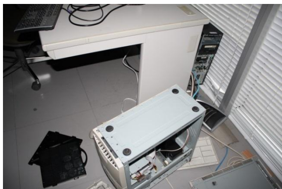
写真5 パソコン本体・プリンタの落下被害の事例（東日本大震災）
