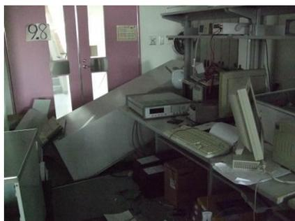
図 2 東日本大震災時に生じた本棚転倒による閉じ込め危険性
