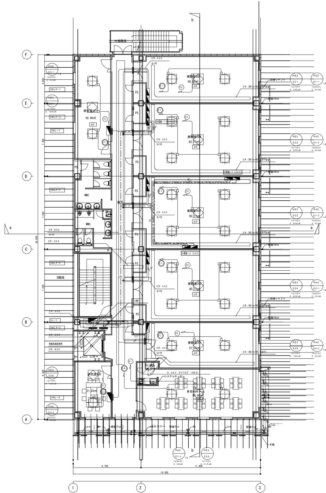
3階幹線（電灯幹線・動力幹線）配線図
