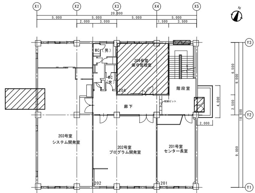
金研スーパーコンピューター棟2階平面図 S=1/200
