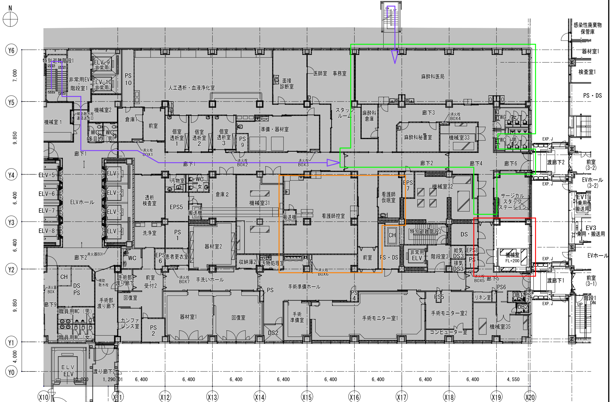
【凡例】 改修工事範囲及び順番： 1番 2番 3番 4番 作業動線： → 診療行為等で使用中： (着工順に明け渡す。) 東病棟平面図 (改修前) S=1/300
