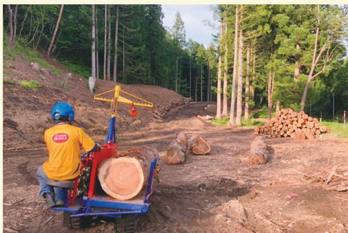
集材機を利用した丸太の運搬
