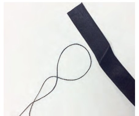
導電性シルク電極(フレキシブルシルク電極)。糸タイプ(左)、リボンタイプ(右)
