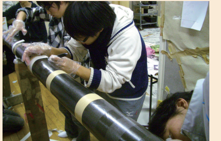
カーボンパイプ製作
