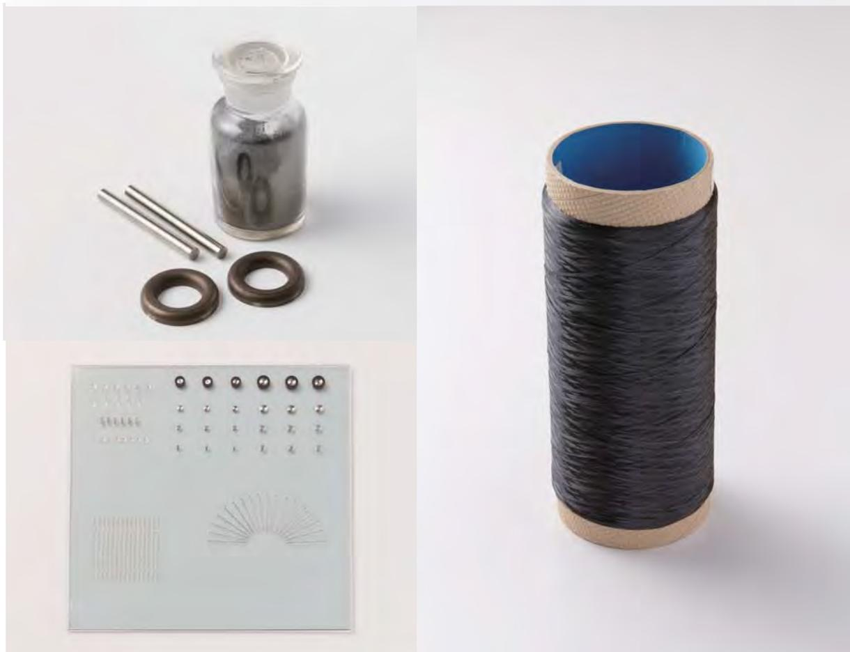
[上]KS 磁石鋼・新 KS 磁石鋼：発明当時世界最高の磁力を誇った永久磁石 [左中] センダスト：スマートフォンなどの電子部品（変圧器）などにも使用されている磁心材料 [左下] コエリンバー製ひげぜんまい：高精度なばね材料として現在も機械式腕時計用のゼンマイ等に使用される。 [右下] 炭化ケイ素繊維：ジェットエンジンの素材にも導入され始めている注目の素材。
