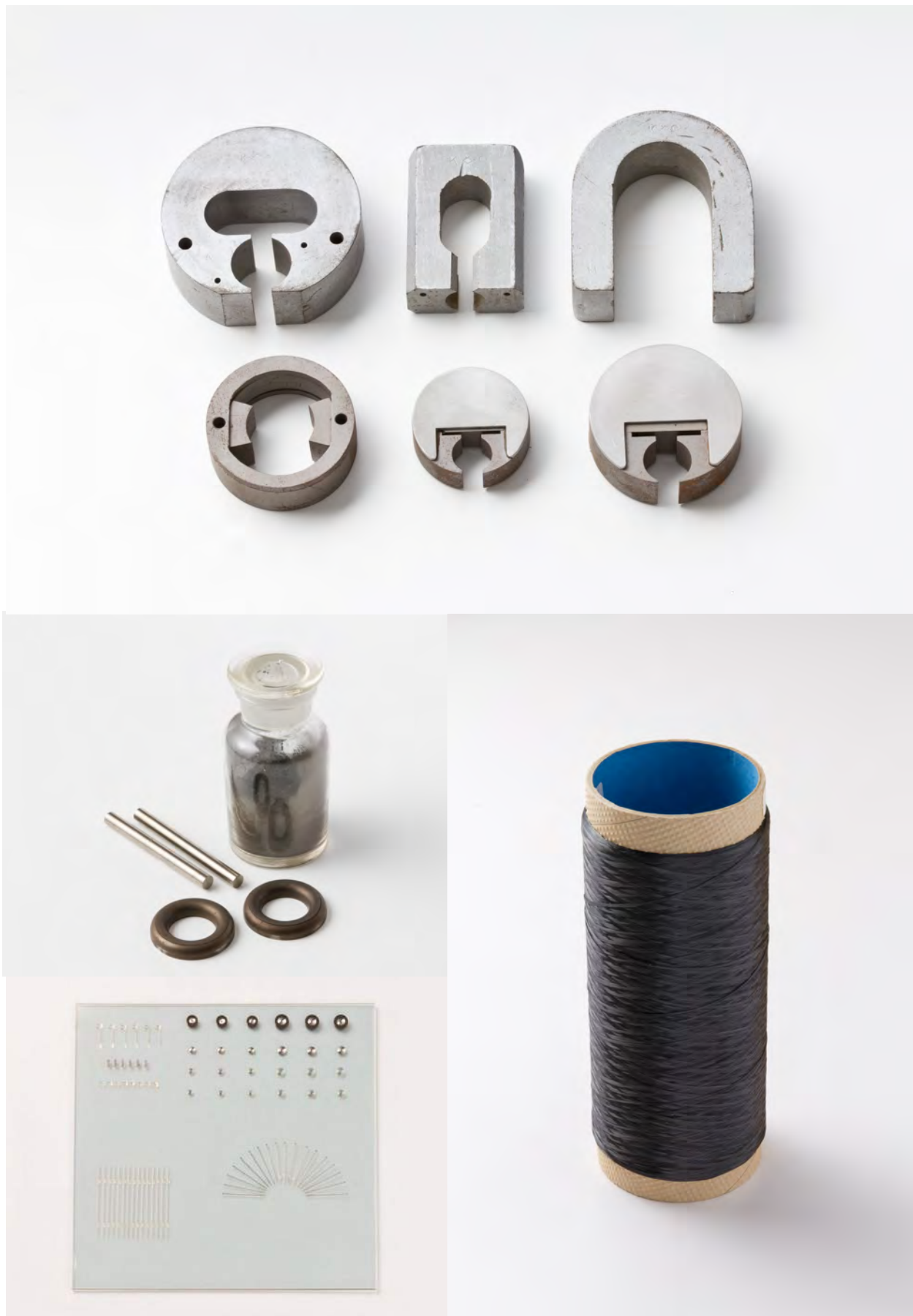
[ 上 ]KS 磁石鋼・新 KS 磁石鋼：発明当時世界最高の磁力を誇った永久磁石 [ 左中 ] センダスト：スマートフォンとフォンの電子部品（変圧器）などにも使用されている磁心材料 [ 左下 ] コエリンバー製ひげぜんまい：高精度なばね材料として現在も機械式腕時計用のゼンマイ等に使用される。[ 右下 ] 炭化ケイ素繊維：ジェットエンジンの素材にも導入され始めている注目の素材。
