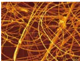
過冷却された合金をガスアトマイズ法で粉砕することによりアモルファス合金ナノファイバーの大量生産に成功
