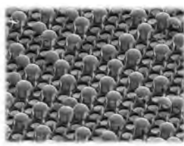
自己組織化により作製した超撥水性と吸着性を併せもつ金属-高分子ハイブリッド膜
