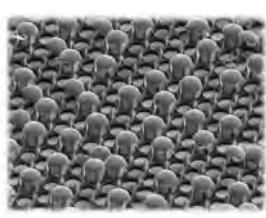
自己組織化により作製した超撥水性と吸着性を併せもつ金属一高分子ハイドロゲル膜
