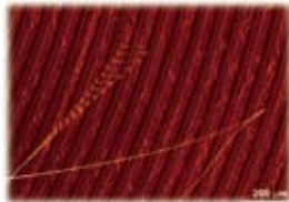
超高強度と高い弾性を併せ持つ金属ガラスナノワイヤの電子顕微鏡像。ナノワイヤの先端が振動している様子
