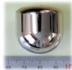
Auf Zirkonium basierendes metallisches Glas (max. 30 mm Durchmesser)
