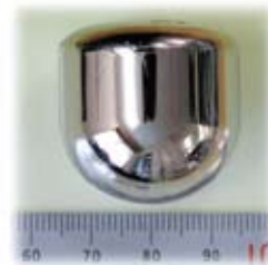
Auf Zirkonium basierendes metallisches Glas (max. 30 mm Durchmesser)
