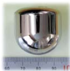
Verres métalliques massifs à base de zirconium (diamètre de 30 mm max.)
