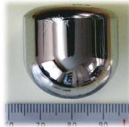
Espejos metálicos basados en Zr (diámetro máximo de 30 mm)
