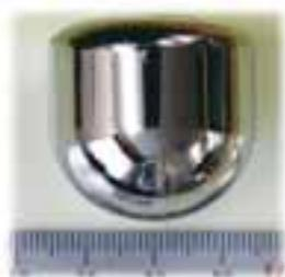
新規Z系バルク金属ガラス(最大直径30mm)
