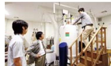
河村教授が提唱する「電池のお医者さん」による診断技術は、サーモグラフィ(体温計)、画像診断(レントゲン・MRI)、AE測定装置(聴診器)などを駆使して行う。写真は磁気共鳴画像装置(MRI)。
