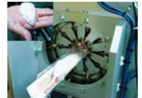
Das Kleintier-Halbleiter-PET-Gerät hat eine hohe räumliche Auflösung von weniger als 1 mm FWHM und ist das erste der Welt. Es ermöglicht biomedizinische Experimente mit Mäusen.
