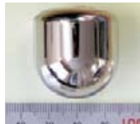
Nuevo vidrio metálico masivo con base en Zr (diámetro máximo de 30 mm)
