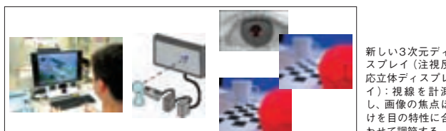
仮想質感の再現：対象の立体形状を画像計測するとともに、プロジェクタで計算された映像を投影して、仮想的な「異なる質感」を実物で再現する。
