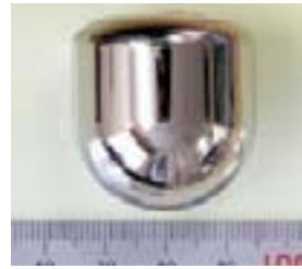
Neues Metallglas aus Zirkonium (Zr) (max. Durchm.: 30 mm).
