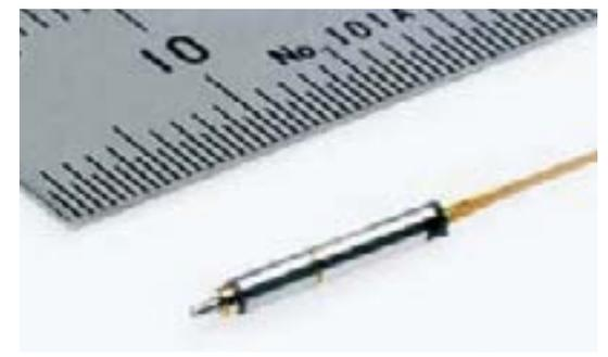
金属ガラス製マイクロギヤを内蔵したモータは、従来の鉄鋼材製マイクロギヤに比べて10倍以上の高い耐摩耗性を持つことから、ギヤードモータの超小型化と高負荷特性が実現できた。このギヤードモータは内視鏡やカテーテル等の先端医療機器の駆動源として実用化を目指している。
