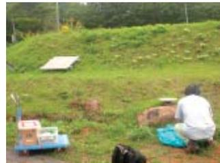
理学研究科が代表となる合同観測グループによる、GPS観測の臨時観測装置設置の様子。人物の前にある円盤状の装置がGPS受信アンテナ、後方の土手斜面の四角形の装置は電源を供給するための太陽電池パネルである。この太陽電池により、地震災害で停電した場所でもデータを取得することが可能となる。
