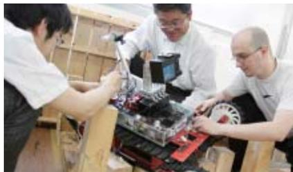
「kenaf(ケナフ)」(探査用クローラロボット)。安全な場所から無線 LAN を用いて遠隔操作し、3次元形状などを計測できる。
