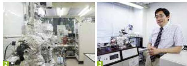
【写真1】 クリーンルームにてより高精度なプラズマエッチング技術によるデバイス製造の研究を行っている。【写真2】 負イオンによる高効率低エネルギーの中性粒子ビームの生成装置を開発している。【写真3】 「もう一度半導体立国の名を取り戻したい」と寒川誠二教授は言う。
