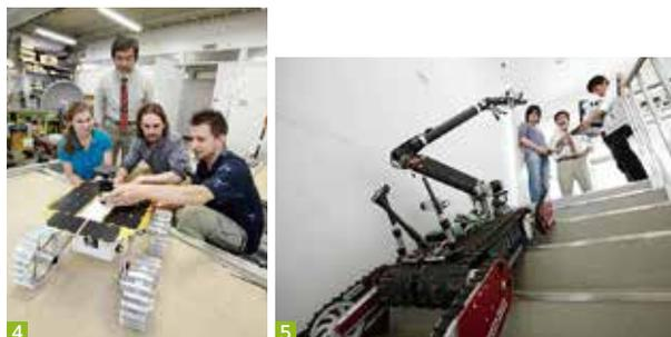
【写真4】研究室に設置された砂場で実験が繰り返される探査ローバー。ロボットは現場でしっかり動けるかどうかポイント。【写真5】急傾斜の階段も登ることができる「レスキューロボット クイーン」。放射線に対するノウハウもあり、福島原発事故でも活用されている。
