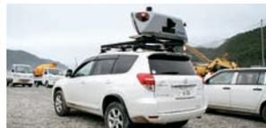
■沿岸部での車載装置による測量
