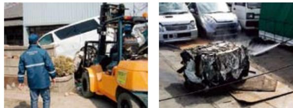
多賀城市の被災車両調査と撤去作業支援 廃車スクラップの線量計測と除染作業 (宮城県北部)
