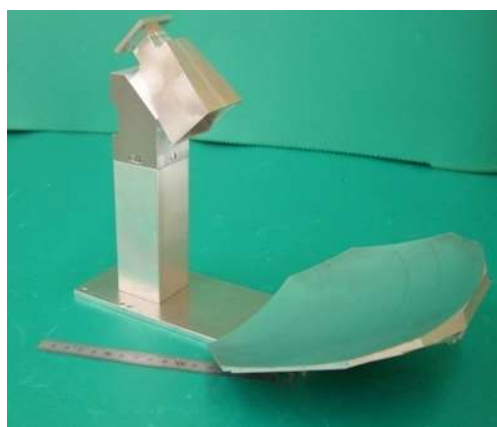
偏心パラボラアンテナ マシニングセンタによる非球面加工
